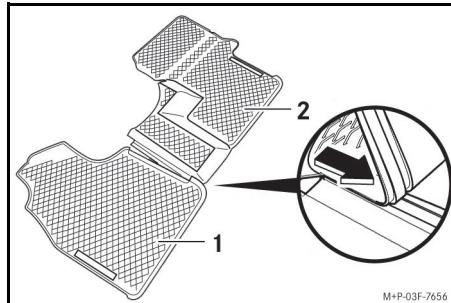
Τοποθετήστε τα πατάκια (1, 2) στο χώρο ποδιών σύμφωνα με το σχήμα τους και ενώστε τα, όπως φαίνεται στην εικόνα.
