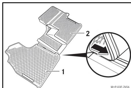
将脚垫 (1、2) 放入脚部位置，使其完全接合，并按图所示进行固定。
